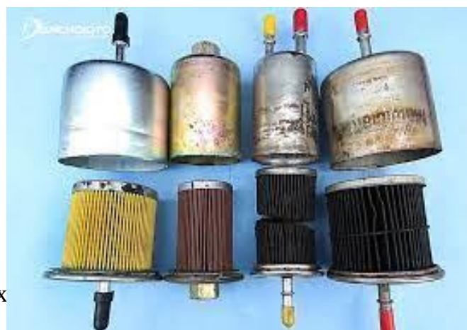
Hình 12.9: Lọc nhiên liệu sau thời gian sử dụng
