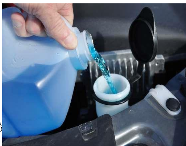
Hình 17.8- Bổ sung nước làm mát động cơ.
