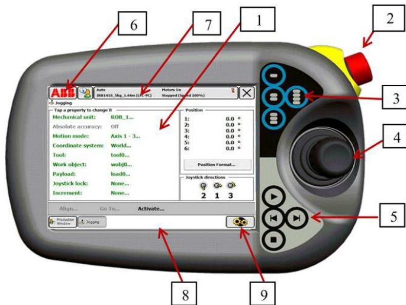
Hình 3-6: Màn hình Điều khiển Flexpendant
