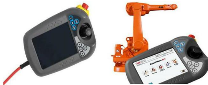
Hình 3-5: Thiết bị điều khiển cầm tay Flexpendant
