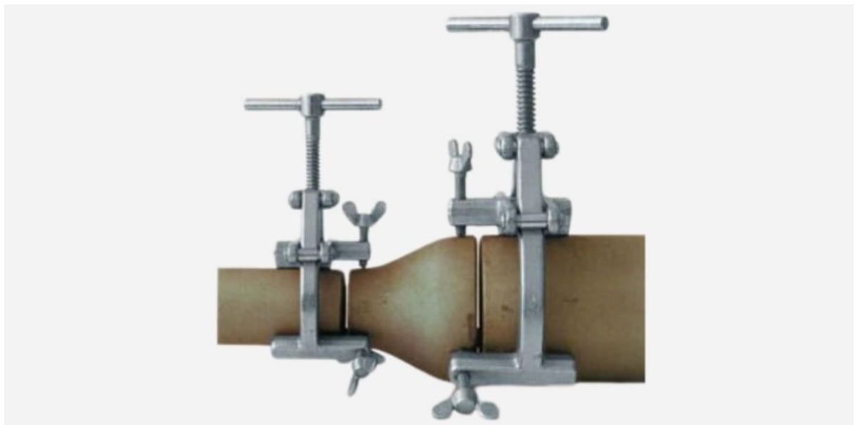
Hình 4.3. Đồ gá định vị và kẹp chặt theo độ đồng tâm của các mặt trụ Nguyên tắc định vị và kẹp chặt: Khi định vị chi tiết, kết cấu hàn phải đảm bảo chính xác vị trí tương quan. Không bị xô dịch khi gá, phôi không bị biến
