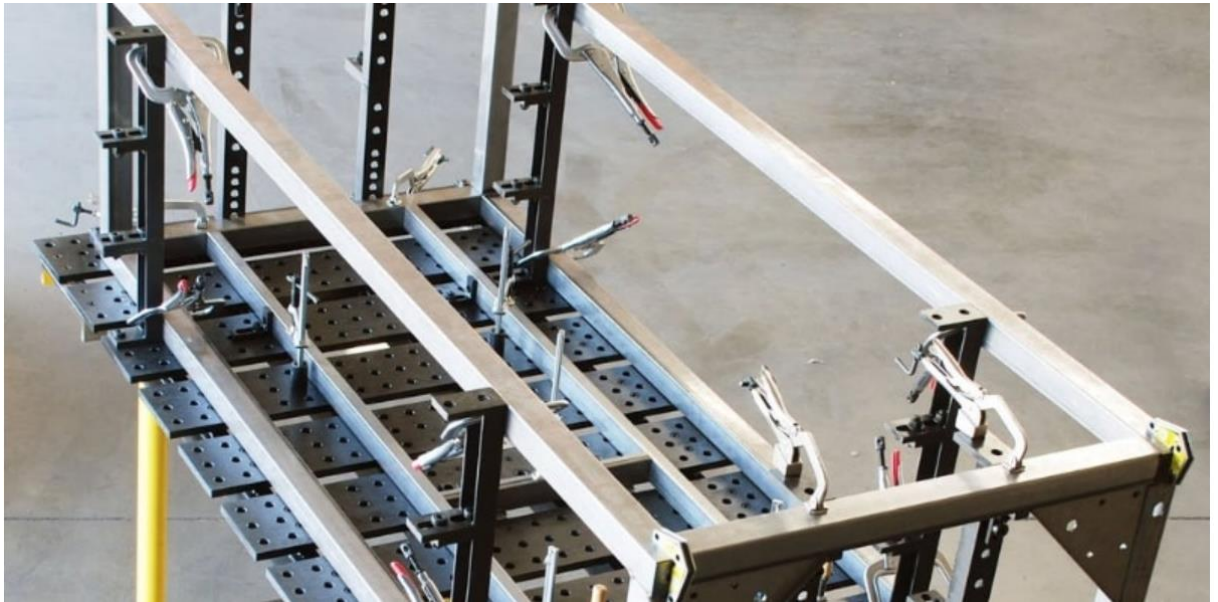
Hình 3.3. Đồ gá định vị kết cấu thanh hộp không gian
