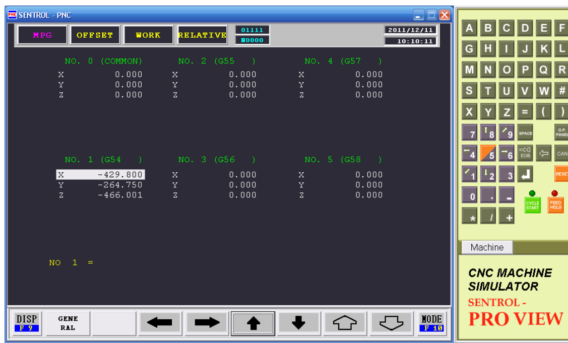
Hình 4.8. Cài đặt (ghi nhớ) gốc phôi bằng G54
