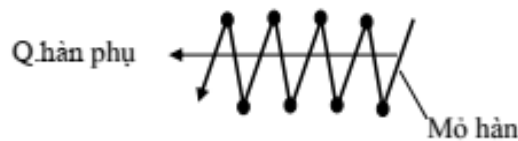
Hình 2-19: Dao động mỏ hàn và que hàn
