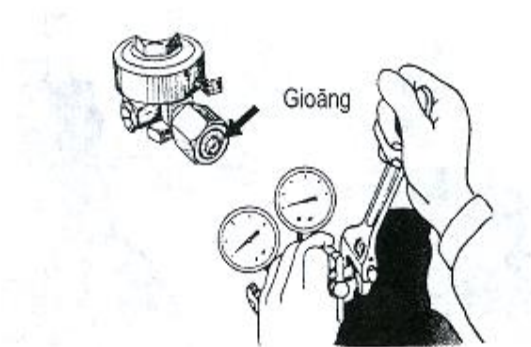
Hình 1-17 : Lắp van giảm áp oxy
