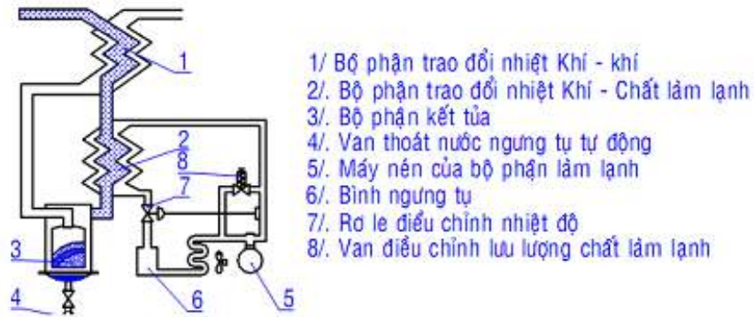
Hình 2.12. Sấy khô bằng chất làm lạnh.
