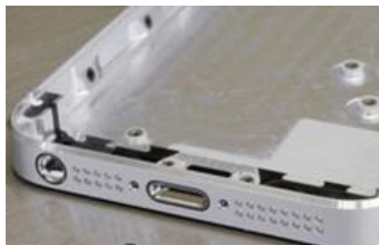
Hình 1.4: Vỏ Iphone 5 được gia công nguyên khối hợp kim nhôm bằng HSM
