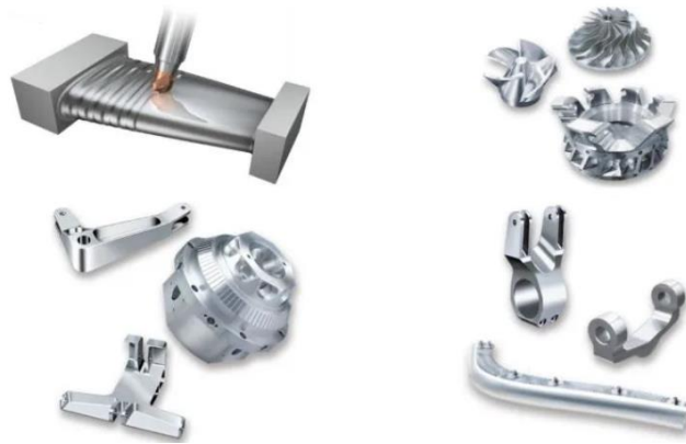
Hình 3.2: Một số chi tiết đòi hỏi độ chính xác cao cần phải được gia công trên máy CNC nhiều trục
