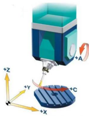
Hình 3.6: Kết cấu đầu dao và bàn máy cùng xoay
