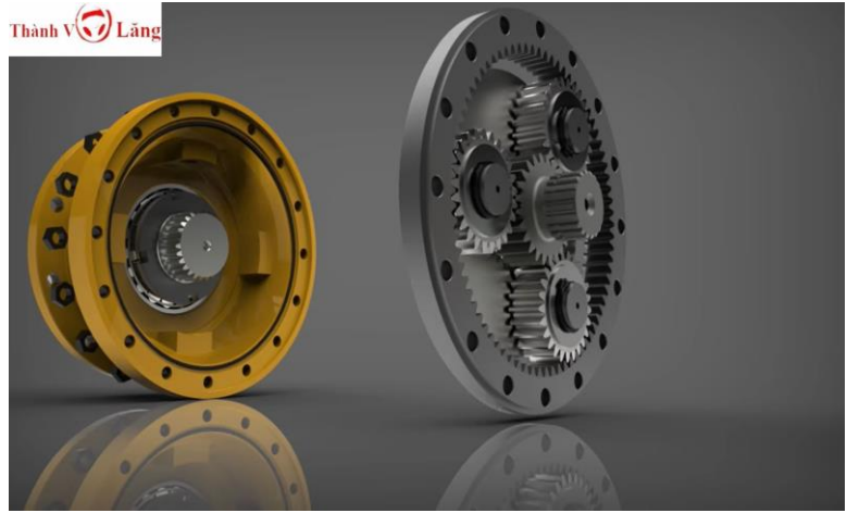
Hình 8.6. Máy khởi động loại bánh răng hành tinh và bộ bánh răng hành tinh.
