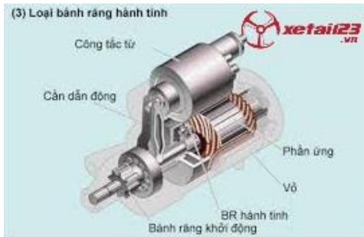
Hình 8.6. Máy khởi động loại bánh răng hành tinh và bộ bánh răng hành tinh.
