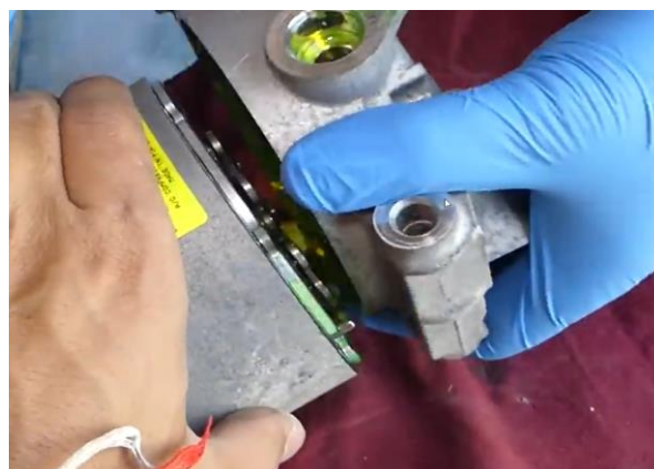
Hình 2.27: Tháo phần đuôi ra khỏi phần thân máy nén
