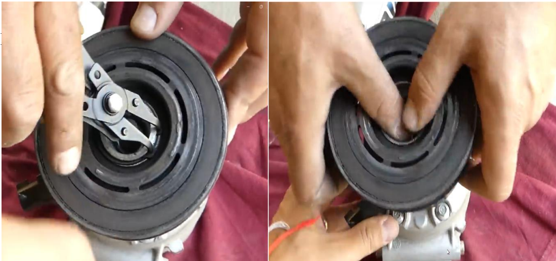
Hình 2.24: Tháo vòng hãm và puly máy nén điều hòa
