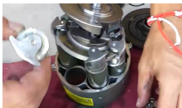
Hình 2.31: Tháo piston và bi trượt của piston ra khỏi đĩa lắ
