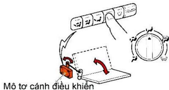
Hình 6.4: Điều khiển cánh hướng gió bằng mô tơ điện
