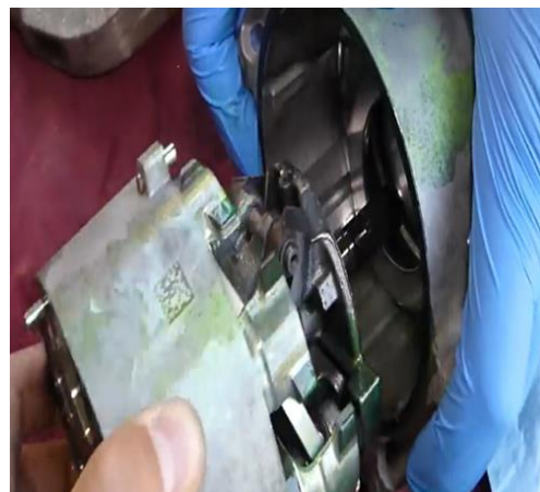
Hình 2.29: Tháo phần đầu máy nén ra khỏi thân
