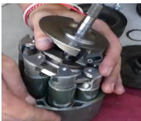
Hình 2.30: Tháo bộ đĩa lắ, các piston ra khỏi xilanh máy nén điều hòa
