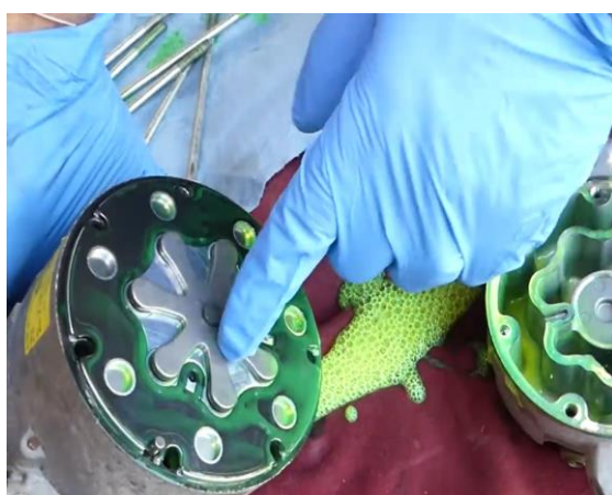
Hình 2.28: Tháo bộ màng xếp tách khỏi máy nén điều hòa
