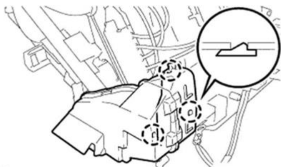
Hình 5.4: Tháo ống dẫn khí số 1
