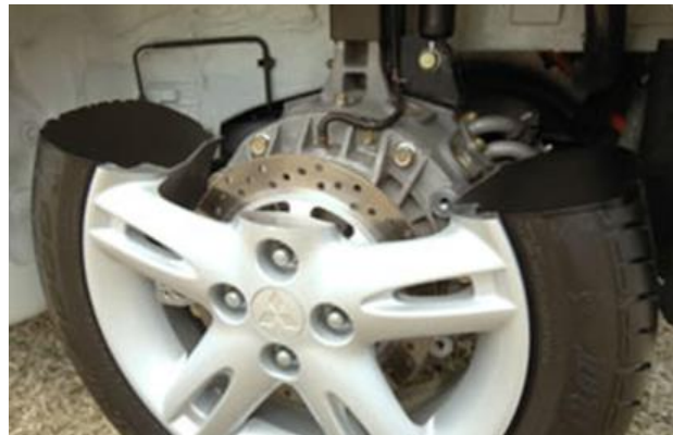
Hình 1-21. Động cơ in-wheel tích hợp trong bánh xe.
